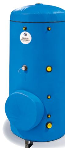
température. Le rapport volume/puissance est calculé en fonction du profil de consommation (importance, durée et espacement des puisages). Le chauffe-eau **avec réchauffeur tubulaire** est décliné sur la base de **2 versions différentes de cuve**, pour être adapté à tous les besoins, en **acier carbone avec revêtement "RC" : gamme "préférence"** ou en **inox 316 L : gamme "TR inox"**.
